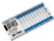
Dräger CMS Chip: Miniaturised Dräger-Tubes.
