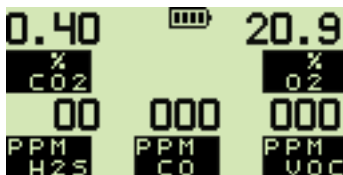
Fig. 3.7 CO2 Sensor - Zero Fault
