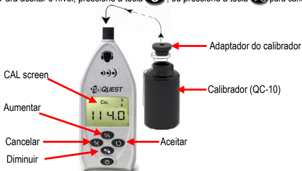
Figura 1-10: Calibração do SD-200
