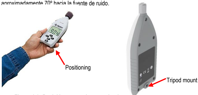
Figura 1-9: Posición y montaje para trípode
