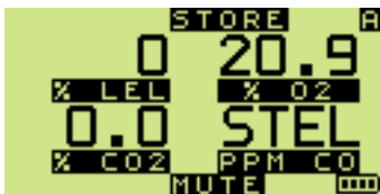
Fig. 4-5 CO STEL Alarm
